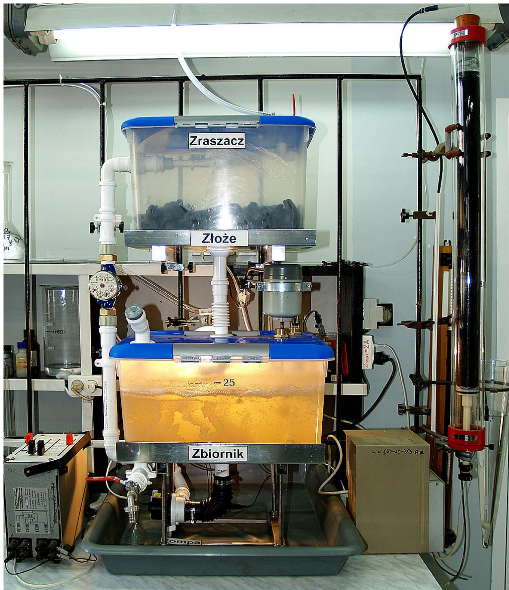
Reaktor osadu czynnego zespolony ze złożem spłukiwanym, oznaczony Nr 1
